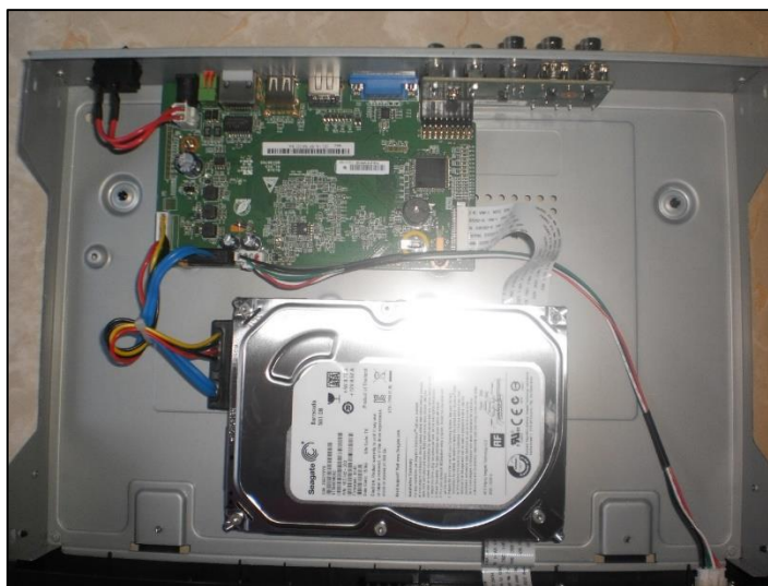
Figura 01: Imagem de Instalação do HDD no DVR
