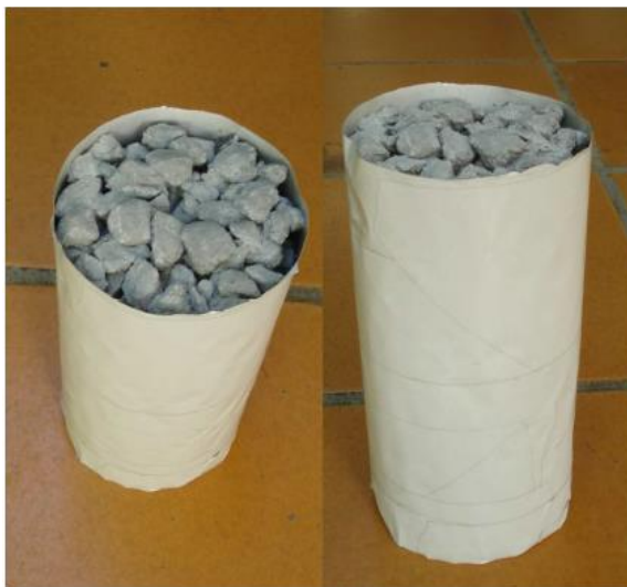
Figura 5: Corpo de Prova para Índice de Vazios
