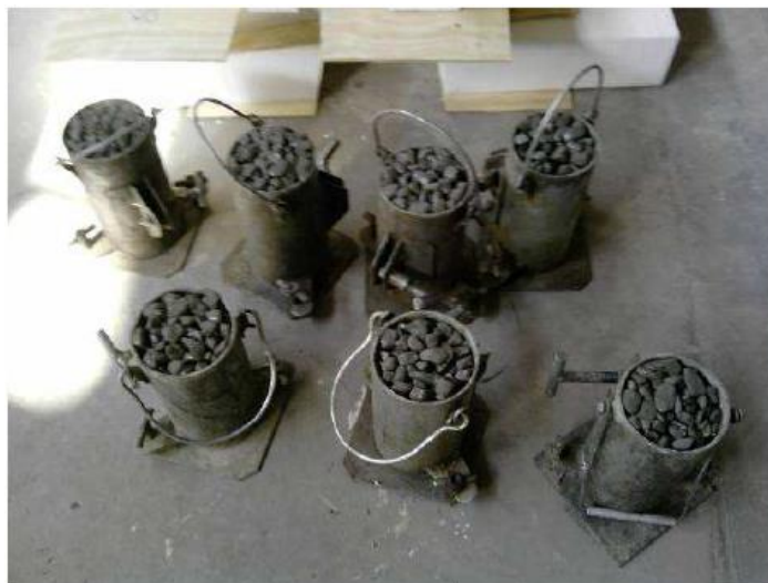
Figura 1: Moldagem dos corpos de prova
