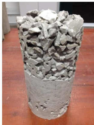
Figura 6: Efeito parede e compactação da pasta de cimento
