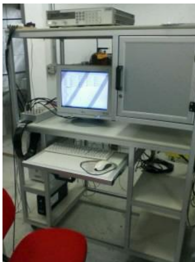
Figura 3 – Fotografia mostrando o sistema de aquisição de dados e controle composto por uma placa dSPACE montada em microcomputador utilizados na bancada experimental.
