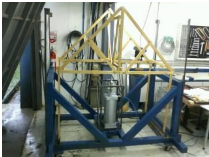
Figura 2- Fotografia da bancada experimental de ensaio de estruturas mostrando o cilindro pneumático utilizado para o acionamento
