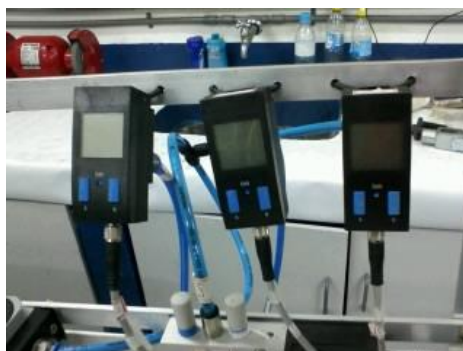
Figura 4 - Fotografia mostrando a servoválvula e os sensores de pressão utilizados na bancada experimental.
